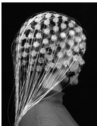
Figur 1.1: Et EEG-apparat med 128 elektroder [Nunez and Srinivasan, 2007].
