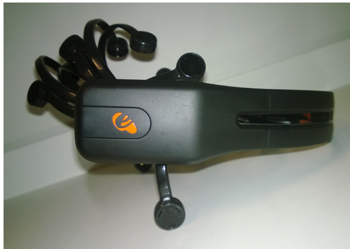
Figur 2.3: Emotivs EEG-apparat med 16 elektroder.
